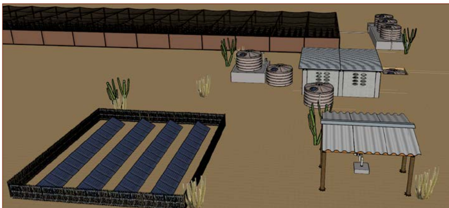
Modell des Projekts: Vorn links die Photovoltaikanlage, vorn rechts die überdachte Wasserausgabestation, direkt dahinter das Anlagenhaus mit der Umkehrosmoseanlage und hinten im Bild das Gewächshaus nach dem „Seawater Greenhouse Prinzip“
